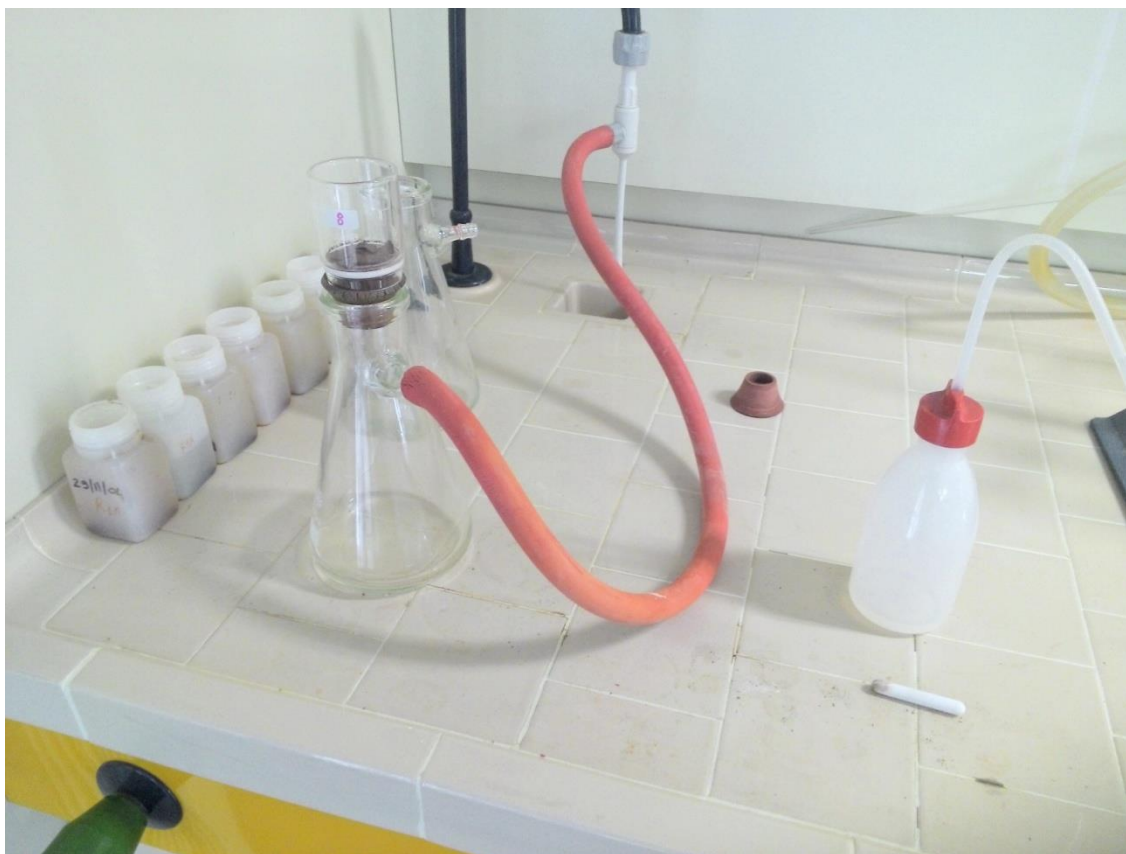
Figura 25. Filtro Gauch posizionato sull'estrattore del vuoto.
