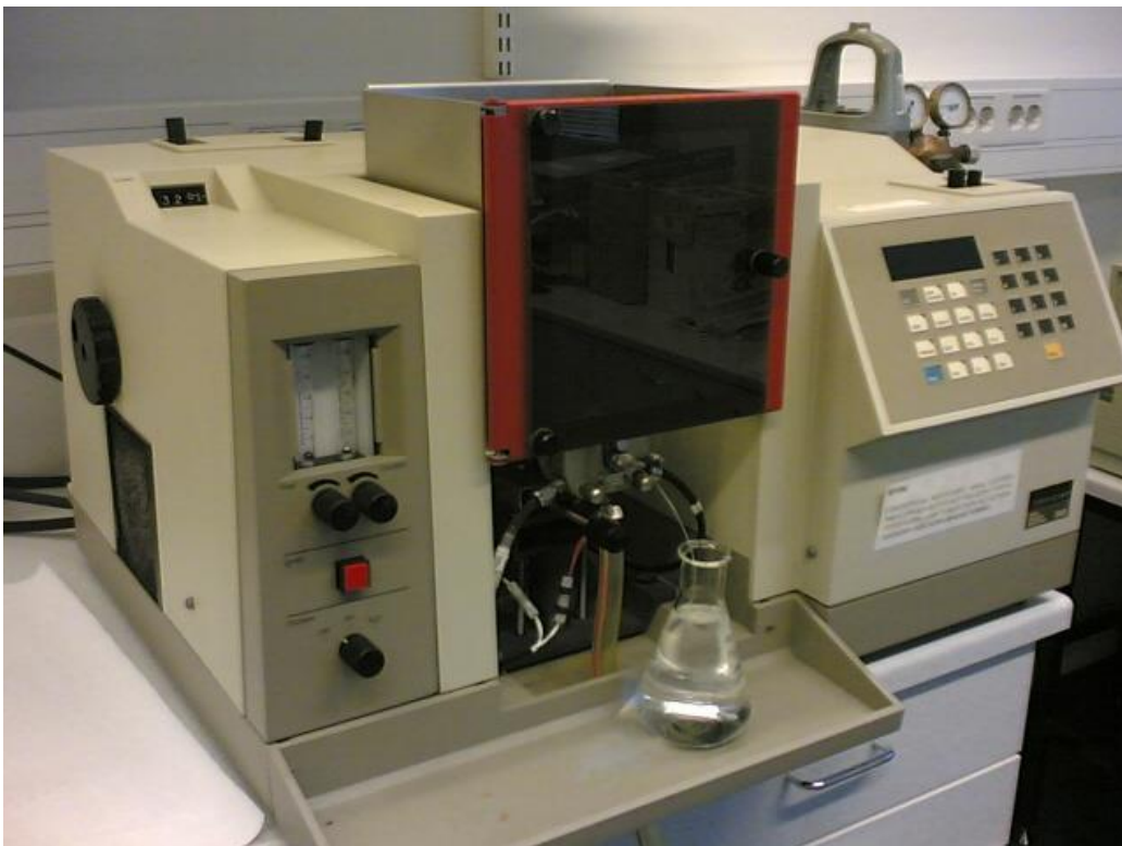
Figura 16. Strumento per la spettroscopia di assorbimento atomico.
